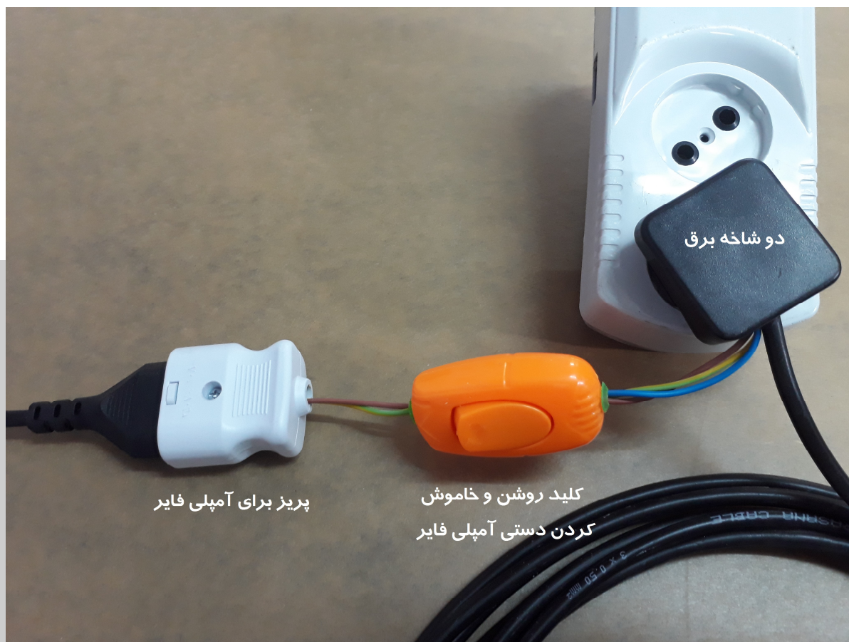
نحوه اتصال کابل برق تابلو به آمپلی فایر
