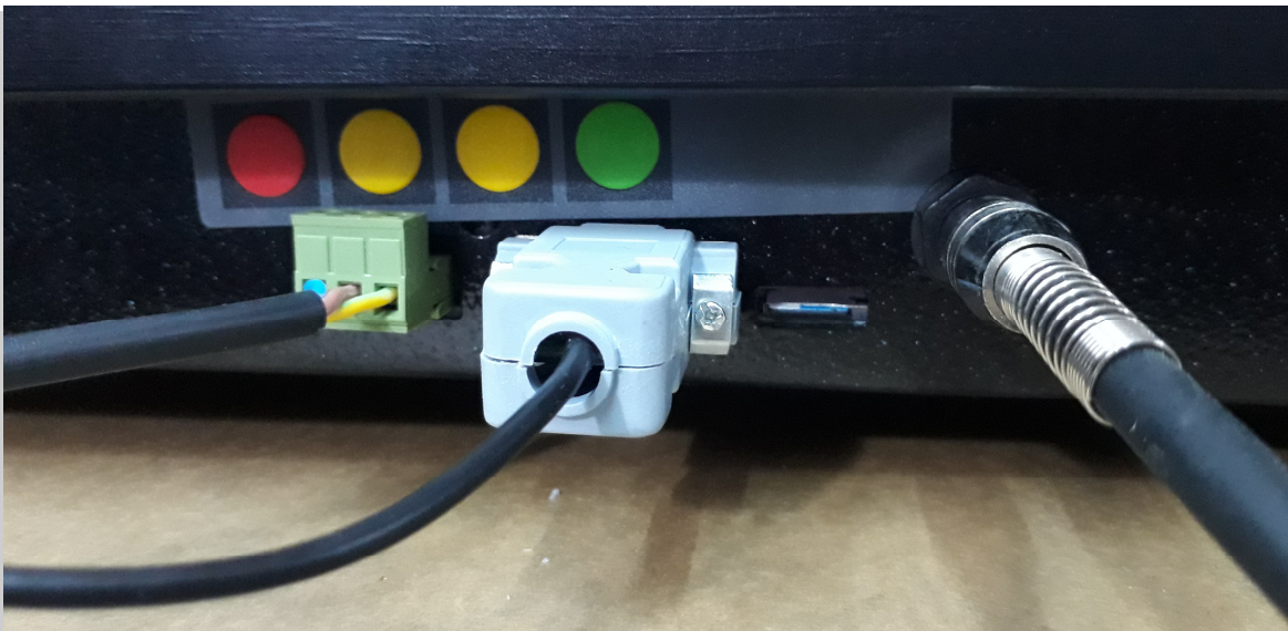
نحوه اتصال کابل برق و کابل صوتی و GPS
